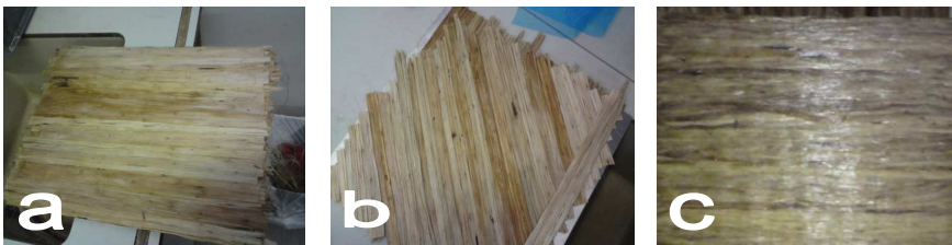
Fig. 1. Stacking sequence of BWB jute preform; a) 0/0/0/0, b) 0/+45°/-45°/0 and c) 0/90°/90°/0.
